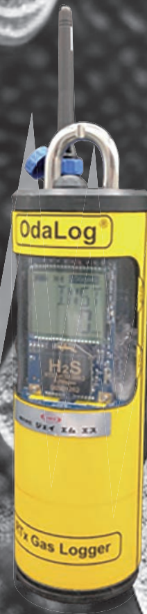
無線式定置型ガス濃度測定器 RTx
